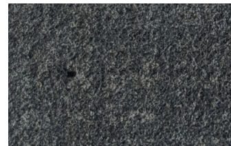
ESEMPIO DI SOFFIATURA (INGRANDIMENTO).
