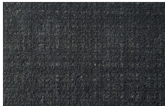
ESEMPIO DI COLORAZIONE NON UNIFORME (INGRANDIMENTO).
