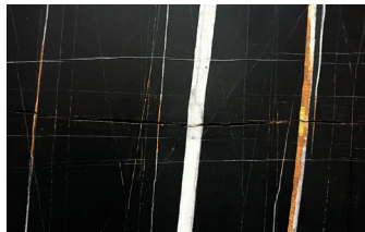
EXEMPLE DE VEINURE ET COLORATION DE LA DALLE.
